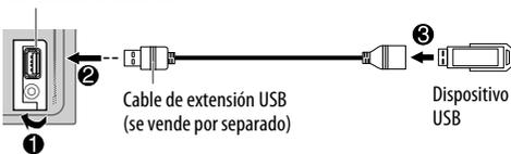
Conecte un dispositivo USB al terminal de entrada USB usando un cable de extensión USB.
